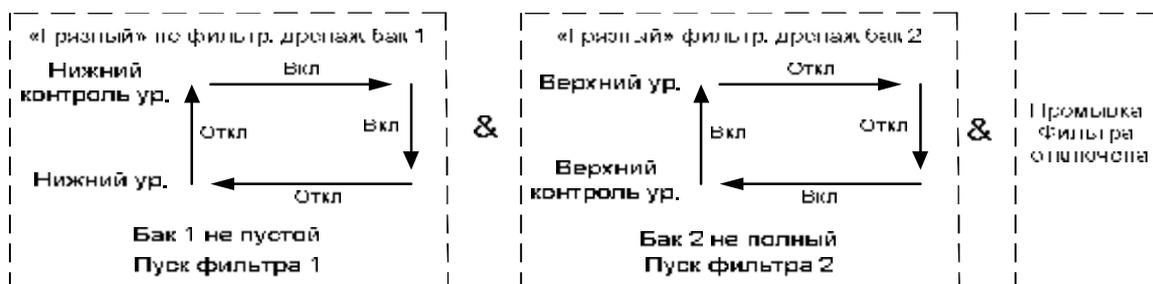
Компьютер может также управлять узлом фильтрации дренажа. Сигнал на разрешение фильтрации дренажа возникает, когда выполняется 3 условия:
